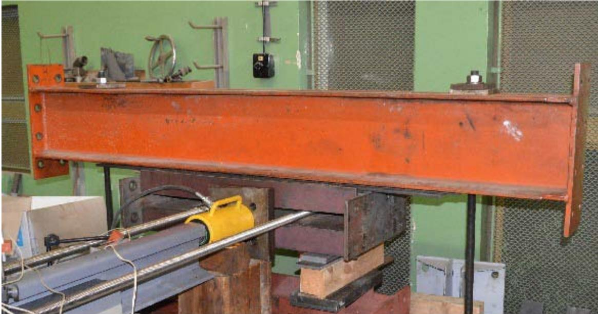
*Figure-4.30: The longitudinal Load Cell*
