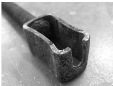
Přípravek pro uchycení hřebu (deformováno po zkouškách)
