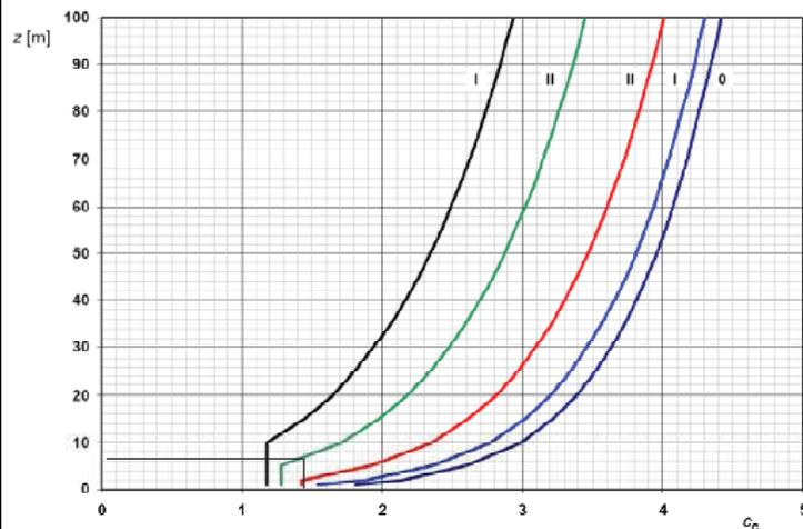
Obrázek 4.2 – Součinitele expozice  $c_e(z)$  pro  $c_0 = 1,0$  a  $k_1 = 1,0$
