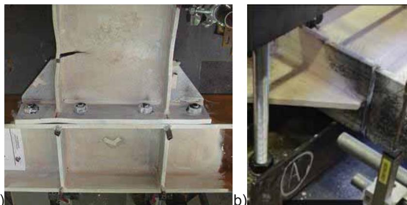
Obrázek 6.26: Vliv výšky nosníku na tvar porušení pro připoje vyztuženou čelní deskou navrženou na stejnou únosnost, a) ES2-TS-E-C2, b) ES3-XS-E-C1.
