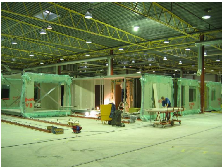
Obrázek 2.3 Plně vybavené modulární buňky jsou vyráběny v továrně.
